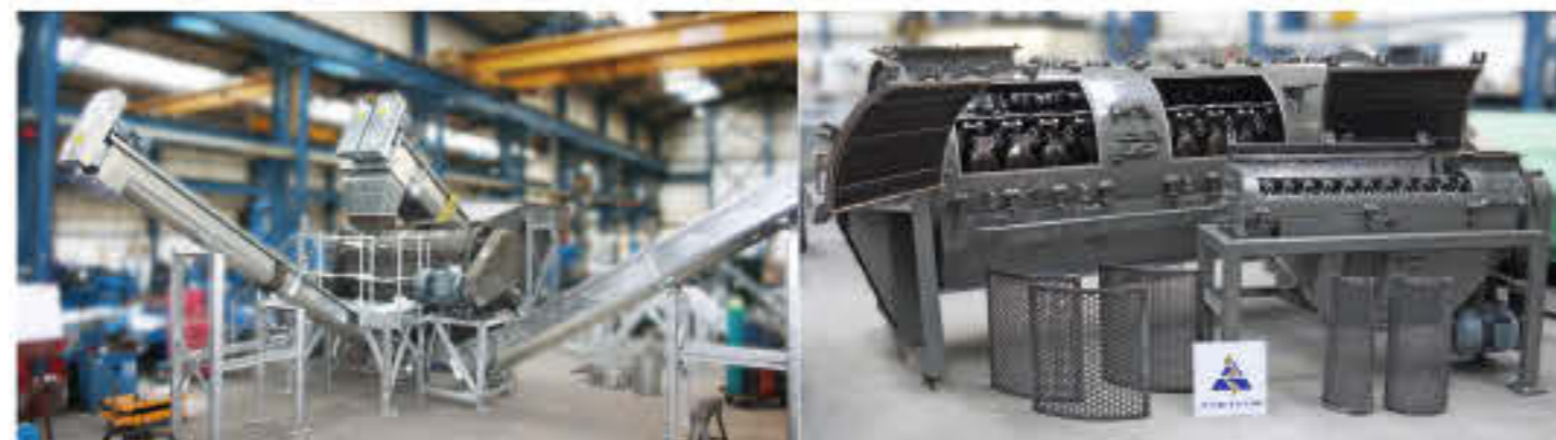
System oddzielania TS3096 do płyt gipsowo-kartonowa, zamontowany w naszym zakładzie produkcyjnym
