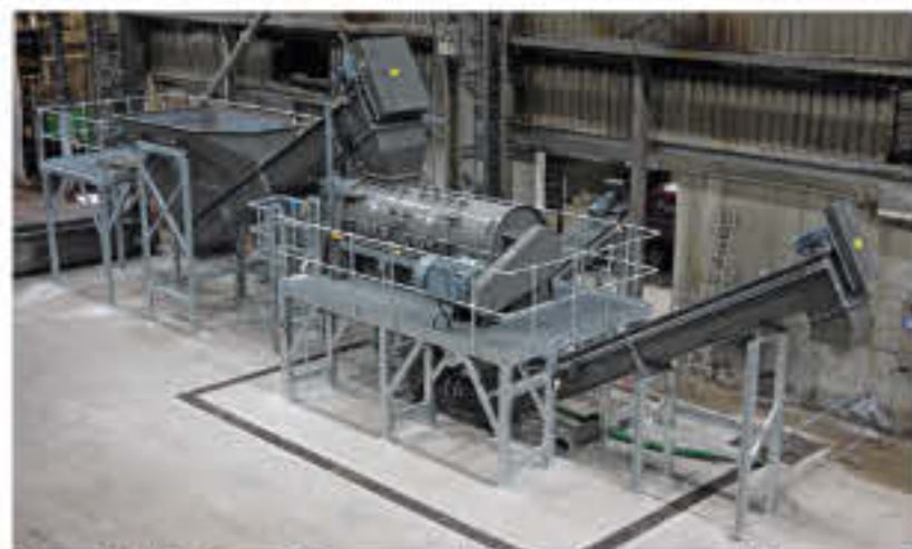
System Turbo Separator TS42120 pozwalający na odseparowywanie do 25 ton na godzinę zmieszanych zużytych opakowań po produktach spożywczych.
