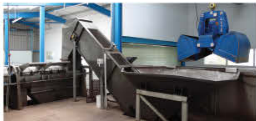
System Turbo Separator TS3096 z gąsienicowym przenośnikiem podającym, pozwalający na odseparowywanie do 10 ton na godzinę zmieszanych zużytych opakowań po produktach spożywczych.
